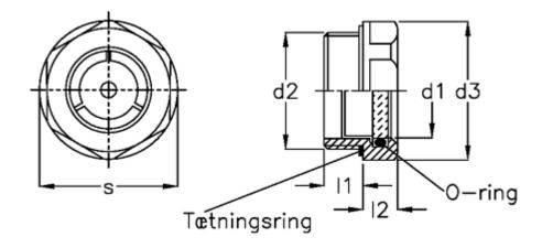
d1 = 24 d2 = M33x1.5 d3 = 40 l1 = 11 l2 = 8.5 Max pressure = -Max vacuum mbar = s = 36
